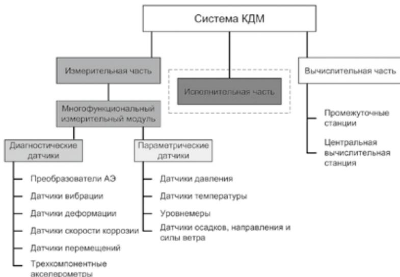
Рис. 1. Функциональная схема СКДМ
