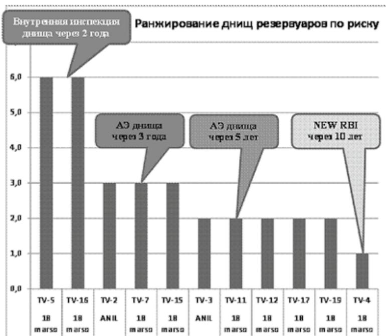
Рис. 11. Графическое представление Плана RBI
