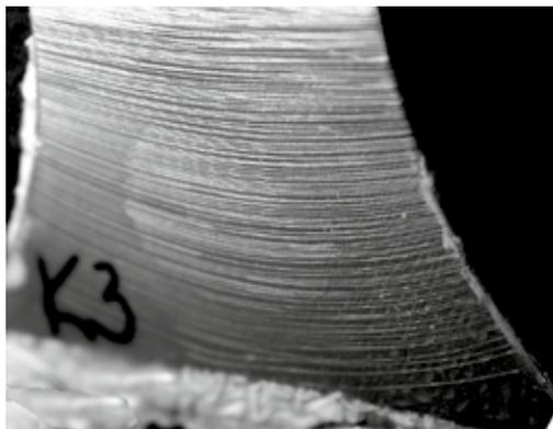
Рис. 9. Картина трещин в тензоиндикаторе после разрушения образца
