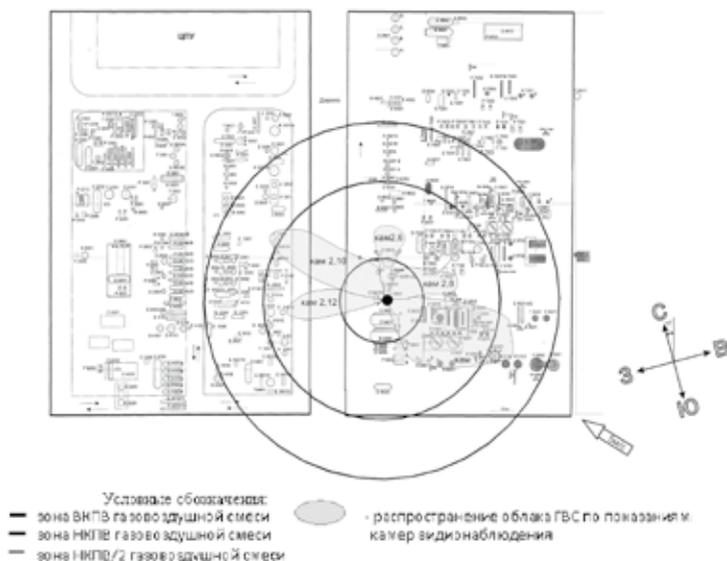
Рис. 2. Распространение облака ГВС по показаниям камер видеонаблюдения и расчетные концентрационные пределы воспламенения
