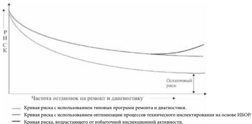
Рис. 2. Базовая концепция снижения риска эксплуатации ОПО за счет оптимизации процесса технического освидетельствования, ремонта и диагностики
