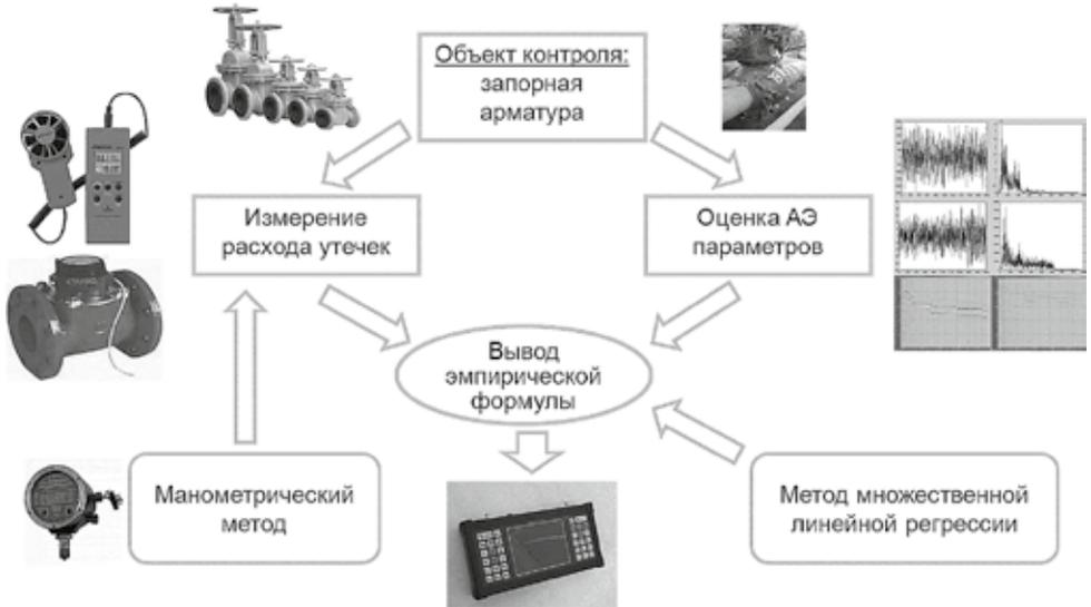
Рис. 3. Схема методического обеспечения акустического течеискания
