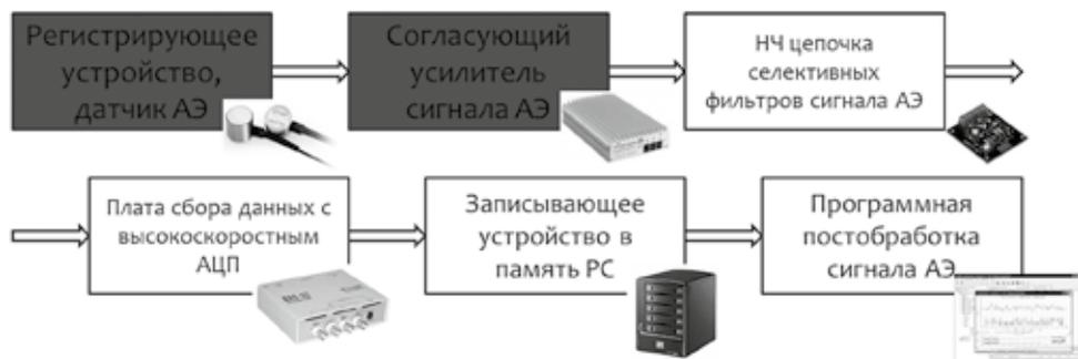
Рис. 8. Принципиальная схема построения системы беспороговой регистрации данных
