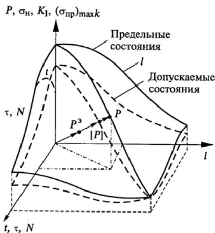
Рис. 2. Схема построения поверхностей предельных и допускаемых состояний при оценках прочности, ресурса и живучести
