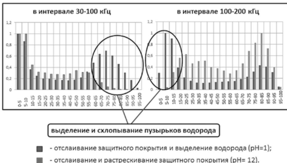
Рис. 4. Распределение спектральной энергии АЭ в зависимости от природы действующих источников (x – доля энергии в заданном интервале частот; y – число импульсов)
