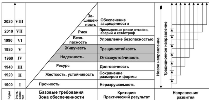
Рис. 3. Общая структура развития подходов к обеспечению работоспособности потенциально опасных объектов
