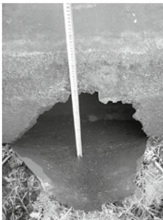
Рис. 5. Пример разрыва трубопровода в результате развития минитечи на коррозионном дефекте
