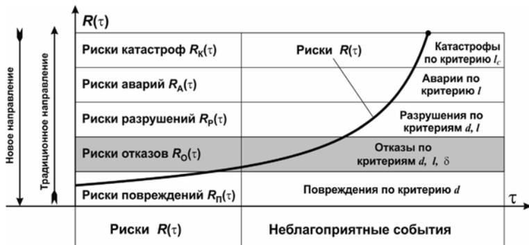
Рис. 4. Алгоритм анализа опасных состояний объектов и соответствующих им рисков
