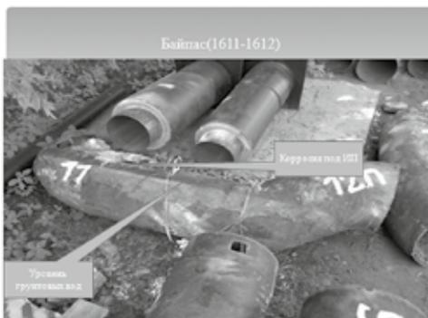
Рис. 6. Коррозия под изоляционным покрытием
