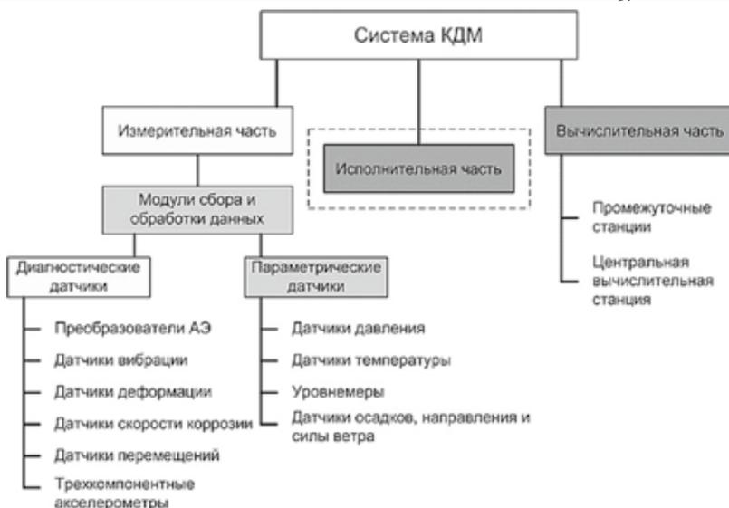
Рис. 1. Обобщенная функциональная схема типовой системы КДМ технического состояния оборудования
