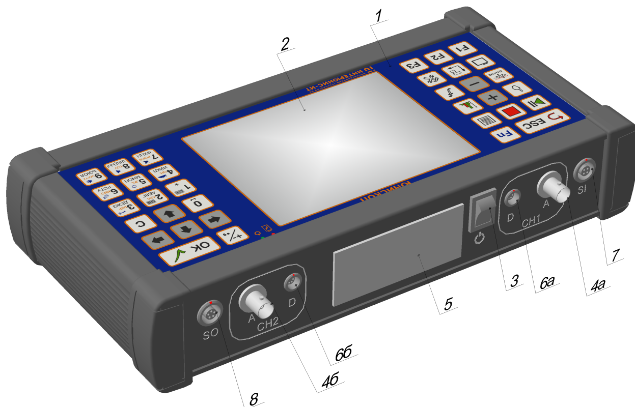
Рис. 1.1. Общий вид ОПБ «UNISCOPE» (1 — клавиатура; 2 — дисплей; 3 — выключатель электропитания; 4а — разъем аналогового канала 1; 4б — разъем аналогового канала 2; 5 — заглушка отсека разъемов; 6а — разъем цифрового канала 1; 6б — разъем цифрового канала 2; 7 — разъем входа синхронизации (опционально); 8 — разъем выхода синхронизации (опционально))
