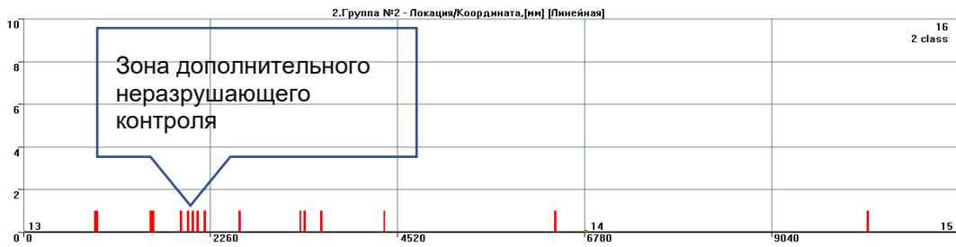
Рис. 10.9. Лоцированные события на выходном коллекторе АВГ при повторном нагружении
