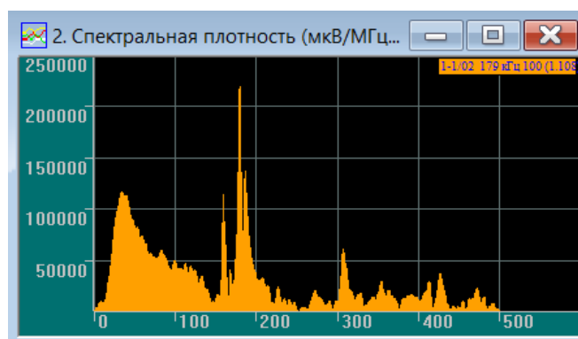
Рис. 7.18. Пример частотного спектра в режиме автоматической калибровки каналов
