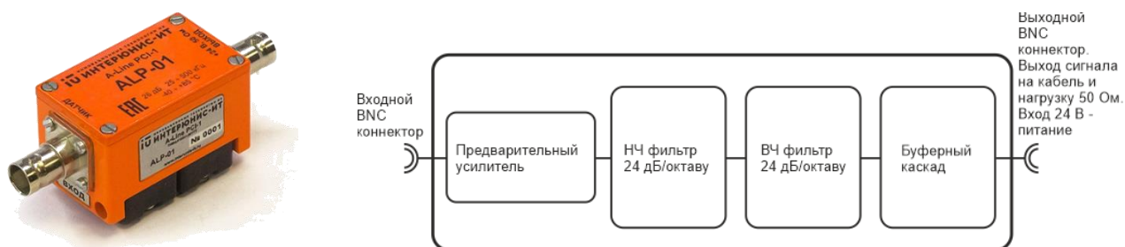
Рис. 3.19. Предусилитель ALP-01, внешний вид и блок-схема
