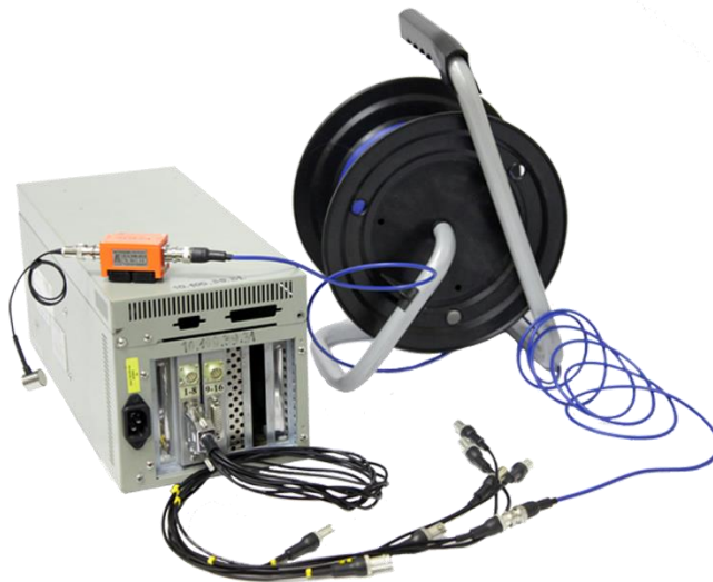
Рис. 3.3. Общий вид АЭ системы типа A-Line PCI в варианте исполнения Ethernet-Box
