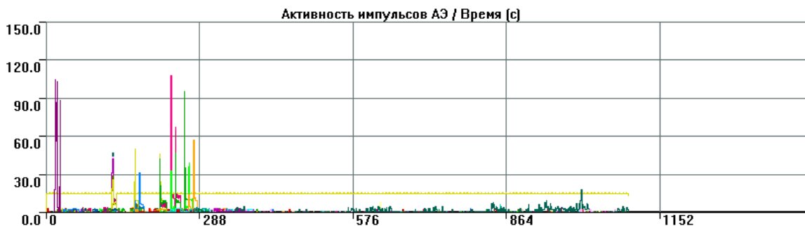
Рис. 4.26. Активность импульсов АЭ в условиях регистрации непрерывной АЭ, канал 14
