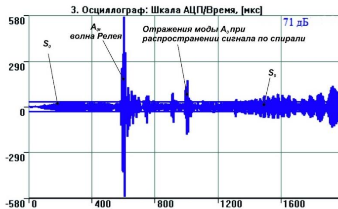
Рис. 4.67. Осциллограмма сигнала, распространяющегося в трубе на дистанции 5 м
