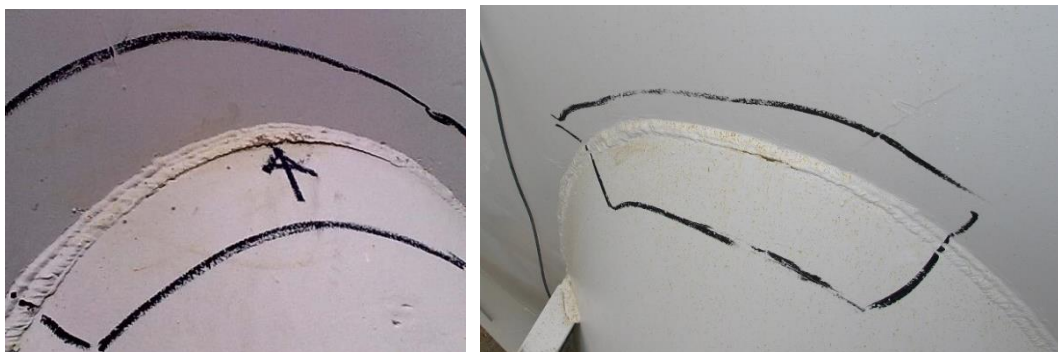
Рис. 10.51. Трещины по зоне сплавления швов приварки опоры у ПАЭ 29 и между ПАЭ 24 и 25
